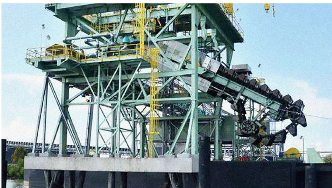
Descarregador CBU – Caçambas em paralelo. Fonte: Planave, 2017.
